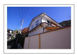
建物外周には十分なスペースを確保し、外壁のメンテナンスが行いやすいよう配慮しました。天井川の地域のため床下の湿度を考慮し床下換気扇を配置し腐食などによる建物の劣化が発生しにくいように配慮しています。勿論交換は外から容易に行えます。
